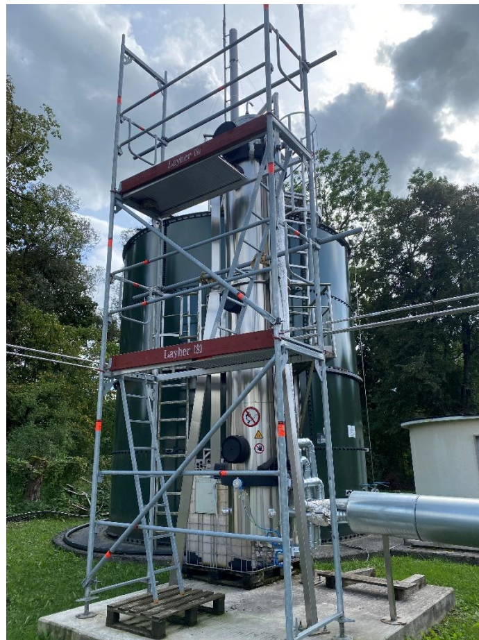
Abbildung 14: Prototyp eines biologischen Methanisierungsreaktors der TUM
